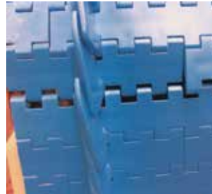
1 Schieben Sie die Bandenden korrekt zusammen.
