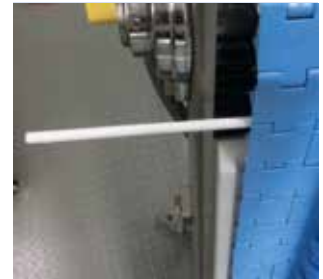
2 Setzen Sie den Stab ein.
